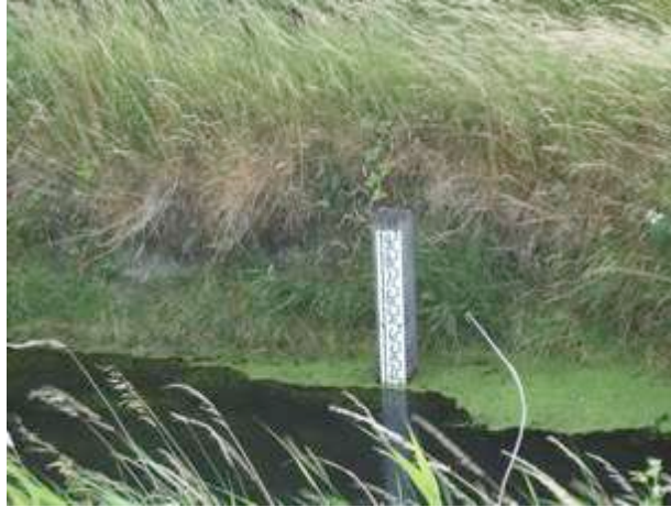
Échelle limnimétrique dans un fossé
